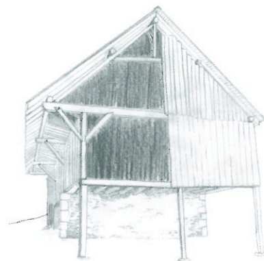
Grange des Bauges avec charpente à compensation de charge (Saint-Jorioz, Haute-Savoie)
