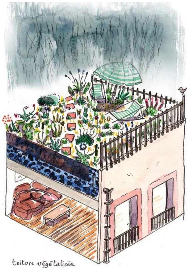
Toiture végétalisée avec végétalisation extensive (sédums et mousses)
