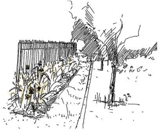
Noue ou fossé pour contenir les eaux de pluie.
