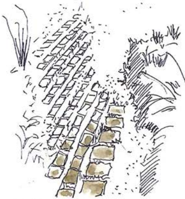
Cheminement piéton facilitant l'infiltration des eaux de pluie.
